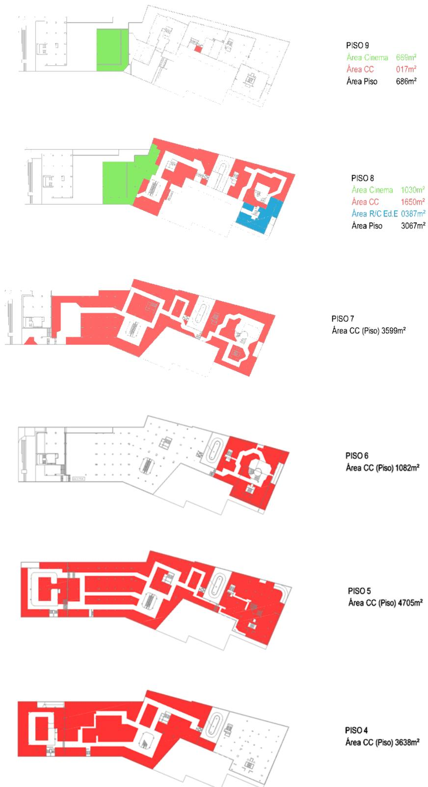
Figura 10. Levantamento da área bruta locável do centro comercial
