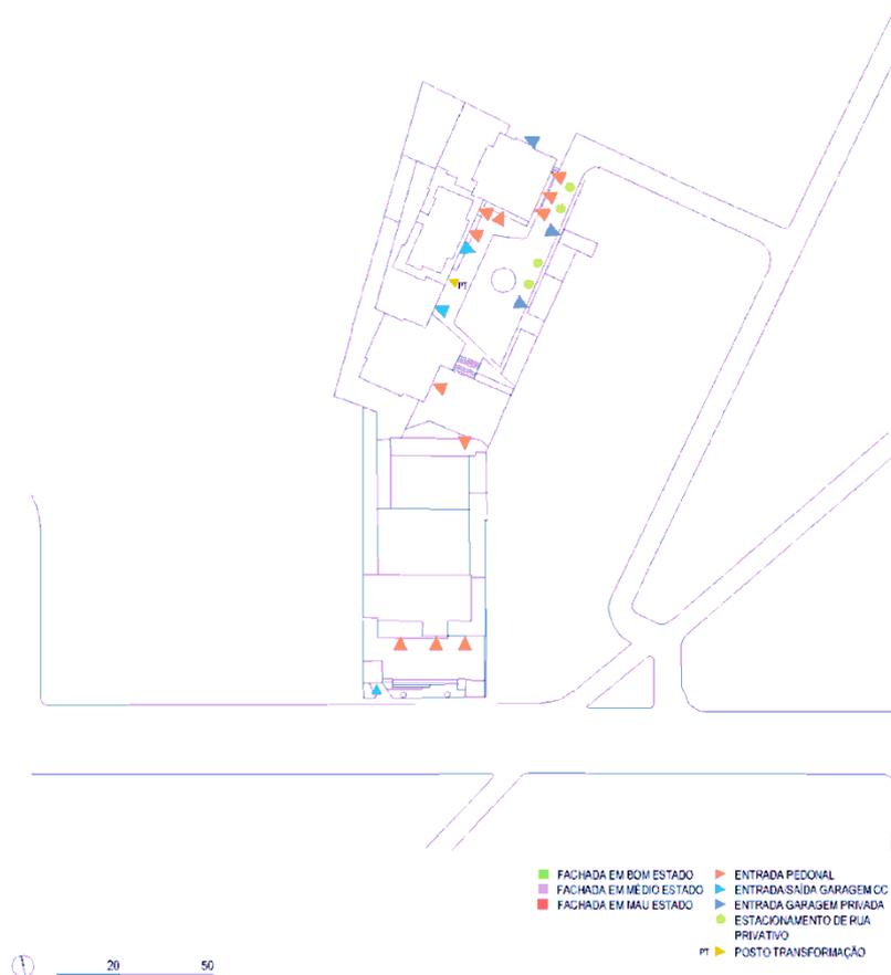
Figura 8. Levantamento de entradas do piso 1
